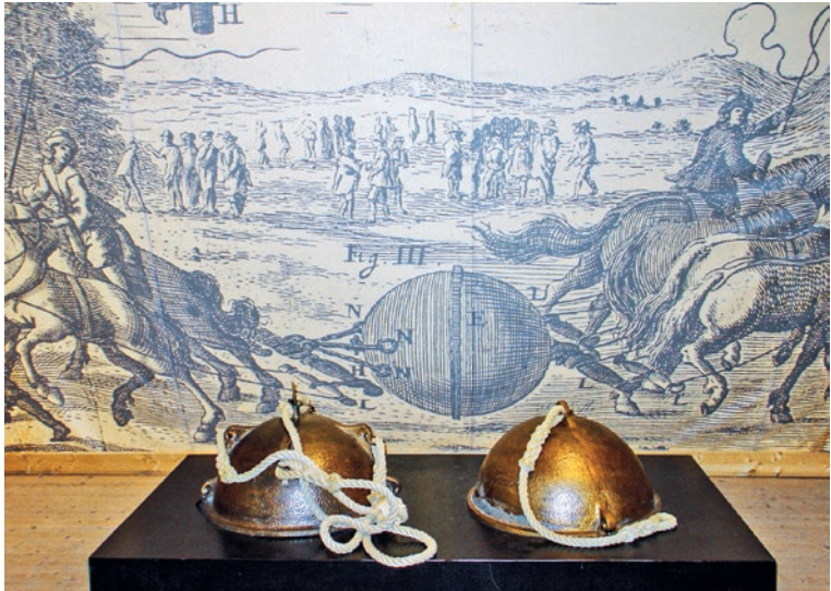
Mit diesen Halbkugeln bewies Otto von Guericke die Existenz des Luftdrucks
