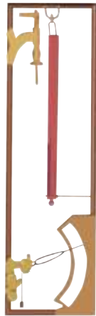
Haarhygrometer zur Messung der Luftfeuchtigkeit
