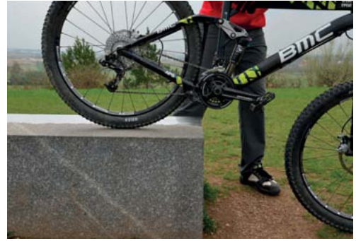
Kontrolle des Abstandes von Kettenblatt zu Kante
