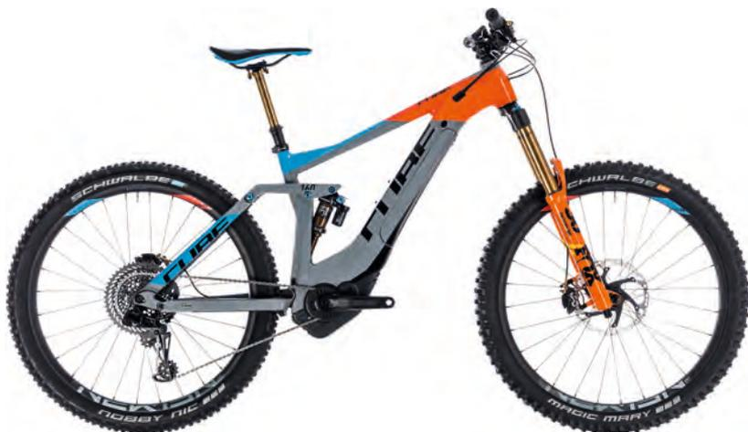
Enduros sind robuste Bikes mit Maximal-Spaß-Faktor. Lange Federwege und robuste Reifen fördern den Spieltrieb in grobem Gelände. Geometrie und Sitzposition sind mehr down- als uphill ausgelegt. Der Motor ermöglicht hier auch längere Bergauf-Fahrten.
