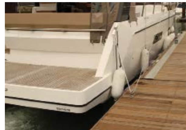
▲ Mit einem Lassowurf ist die Leine über die Klampe gelegt und das Ende an der Heckklampe belegt. Mit Schub gegen die umgelenkte Heckleine liegt das Boot längsseits am Steg.
