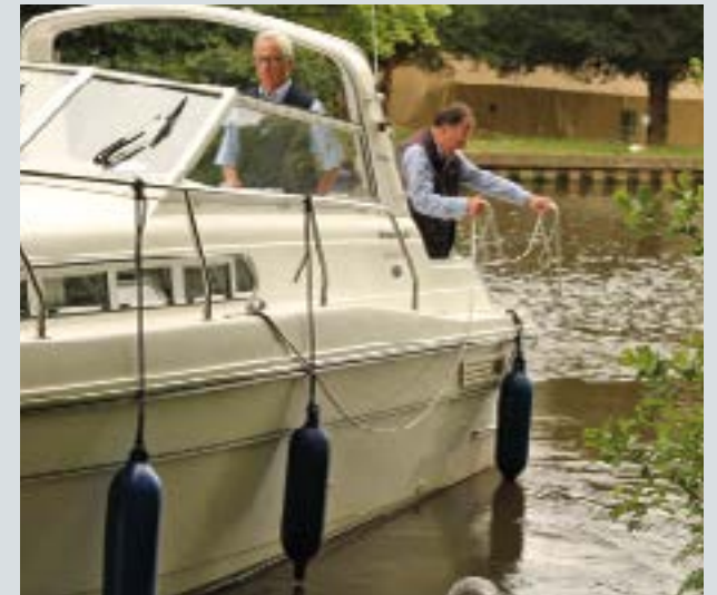
▲ Die Leine ist mit der OXO-Methode an der Mittschiffsklampe belegt und durch die Mitte der Heckklampe geführt. Vier Buchten sind für den Lassowurf geformt.
