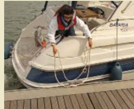
▲ Die Schlaufe wird um die Klampe gelegt.
