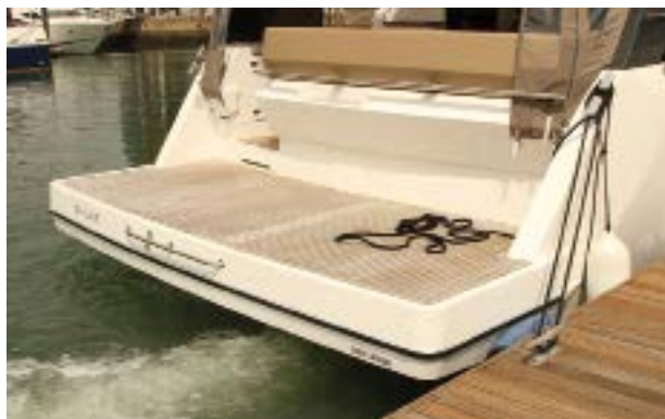
▲ Die Leine wurde mit der OXO-Methode an Bord belegt. Das Boot dampft mit der innen liegenden Maschine in die Leine ein.
