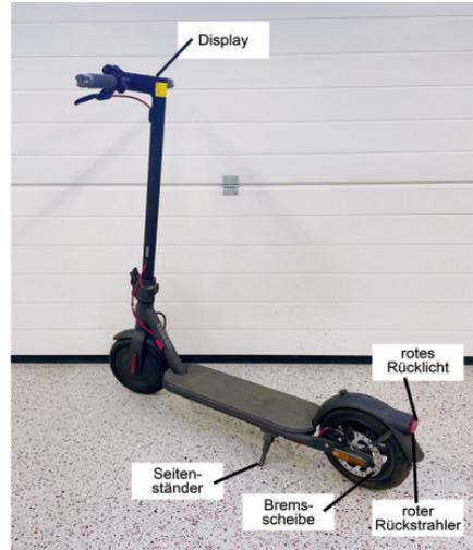
Abbildungen 2 und 3: E-Scooter mit seinen Bauteilen (Front- und Hinteransicht)
